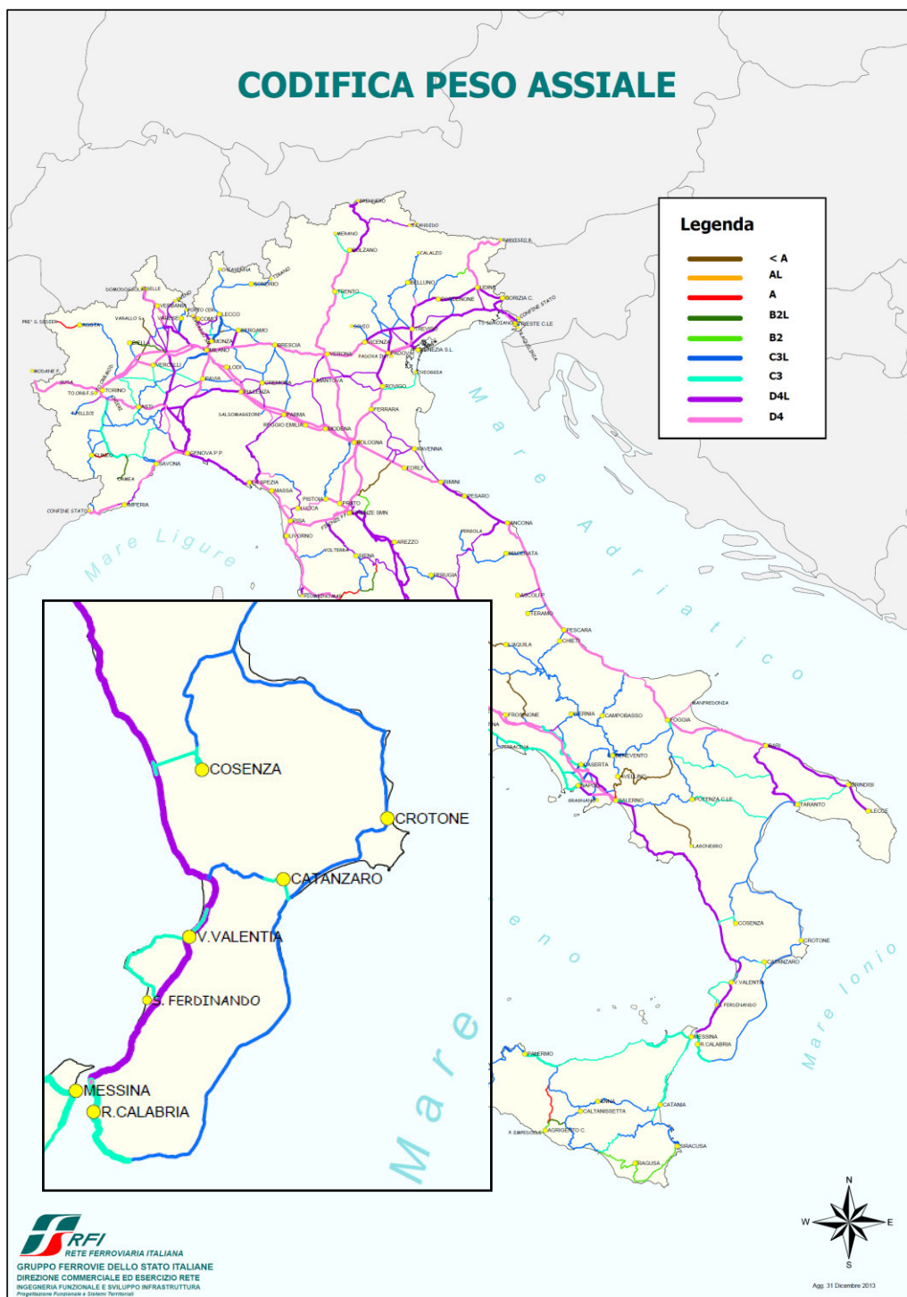
Fig. 2.4.27- Carichi assiali ammissibili sulla rete ferroviaria calabrese e italiana (Fonte: RFI, www.rfi.it , aggiornamento dicembre 2013)
